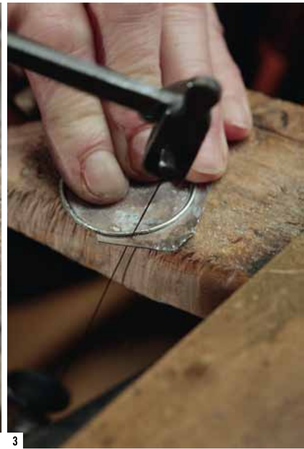
3 Nach dem Schweißen sägt Elgin Espert den Knopf am Rand entlang genau aus.
