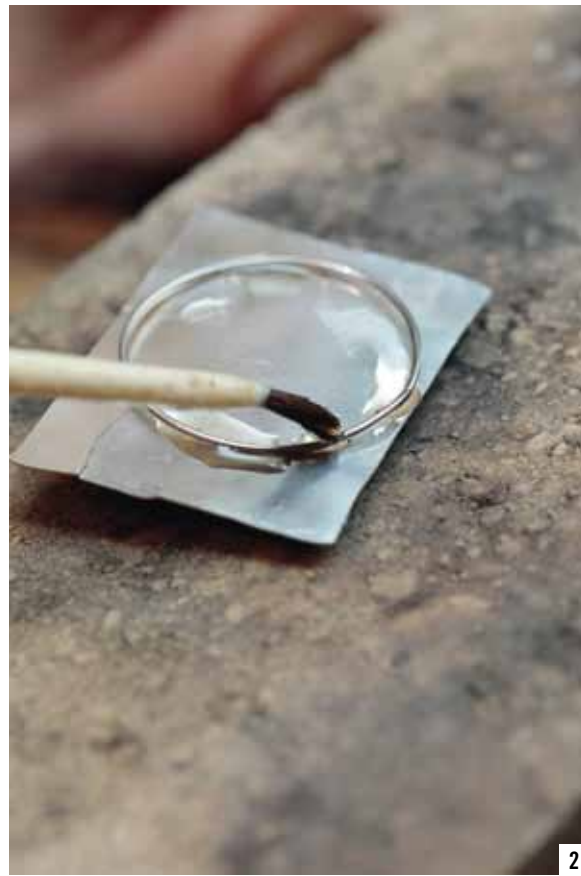
2 Dann kommt der Ring auf die Silberplatte. Ein Flussmittel verhindert, dass sich beim Schweißen eine Oxidschicht bildet.
