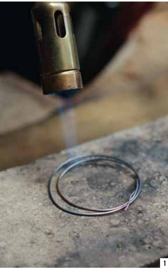
1 Ein Silberring bildet den Außenrand des späteren Knopfes. Die Goldschmiedin schweißt ihn zunächst mit dem Bunsenbrenner zusammen.
